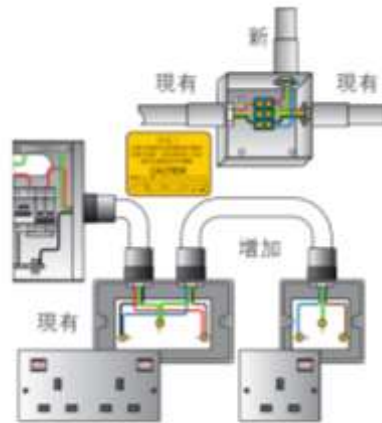
在現有單相裝置進行加裝、改裝或修理工作（現有相線以紅色識別）
